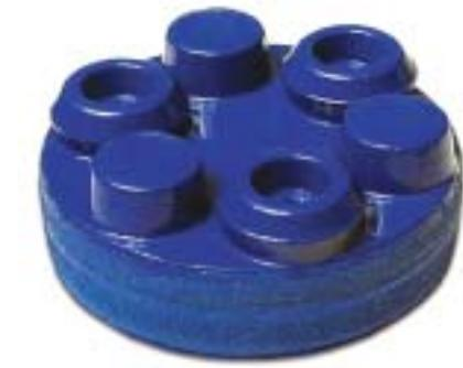
При этом алмазные сегменты, выступая над поверхностью основы, образуют текстуру, обеспечивающую свободное выведение шламов с рабочей поверхности инструмента. В результате исключается, «засаливание» инструмента даже при обработке мягких пород, в 2,5 - 3 раза повышается производительность обработки и качество обработанной поверхности. Использование высококачественных алмазных порошков, а также их высокая концентрация в рабочем слое призвана обеспечить высокий ресурс работоспособности инструмента.
