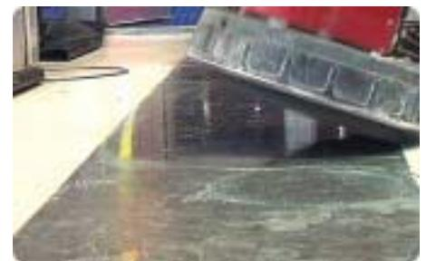
Роторная машина в процессе работы по «кристаллизации» гранита
