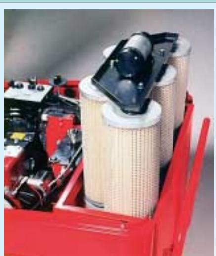
Главный фильтр свипера обычно имеет устройство для очистки встряхиванием — шейкер. Привод шейкера может быть ручным или электромеханическим.
