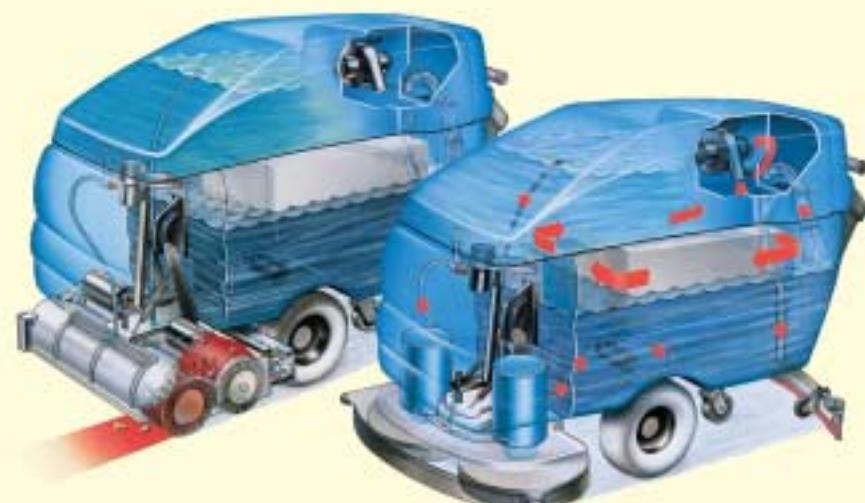
На верхнем рисунке схематично изображены направления движения моющего раствора при работе поломоечной машины; для машины с цилиндрическими щетками также показано движение загрязнений внутри щеточного узла при его работе.
