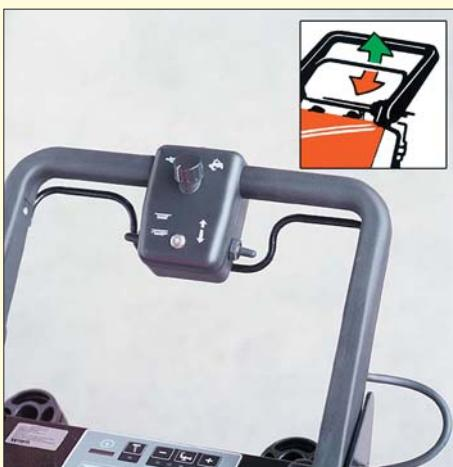
Для быстрой остановки поломоечной машины обычно бывает достаточно отпустить специальный рычаг, который удерживается при уборке.
