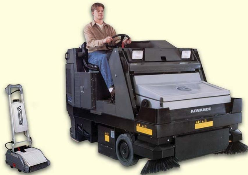
«Давид и Голиаф»: две поломоечные машины с разных краев размерной линейки. Слева: машина валкового типа с шириной полосы уборки 25 см и проводным питанием от сети. Справа: поломоечная машина с водосборным узлом и функцией предварительного подметания с шириной полосы уборки 1700 см, использующая в качестве силовой установки двигатель внутреннего горения.
