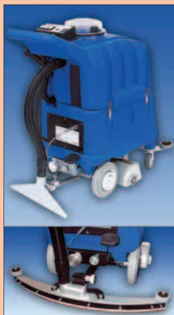
Некоторые модели экстракторов могут трансформироваться в поломоечные машины путем замены ковровой щетки на щетку с более жесткими волокнами и замены всасывающей ковровой насадки на прямой или параболический всасывающий модуль (влагосборник) для твердых покрытий
