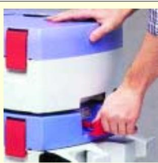
Очистка картриджного фильтра при помощи шейкерного устройства
